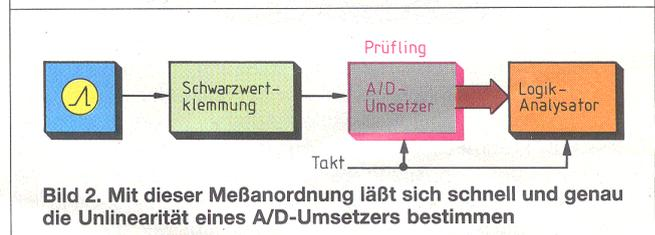
Bild 2. Mit dieser Meßanordnung läßt sich schnell und genau die Unlinearität eines A/D-Umsetzers bestimmen
