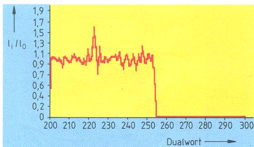
**Bild 3.** Die Darstellung der Reaktion eines A/D-Umsetzers als Histogramm gibt einen guten Überblick über die Unlinearität des Prüflings.
