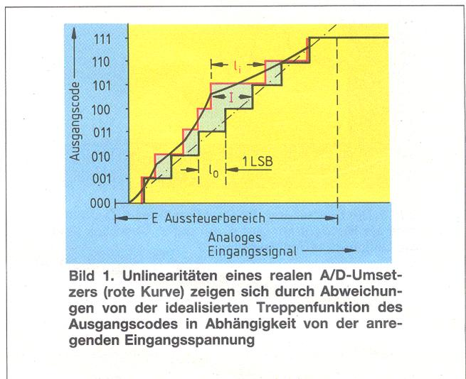
Bild 1. Unlinearitäten eines realen A/D-Umsetzers (rote Kurve) zeigen sich durch Abweichungen von der idealisierten Treppenfunktion des Ausgangscodes in Abhängigkeit von der anregenden Eingangsspannung
